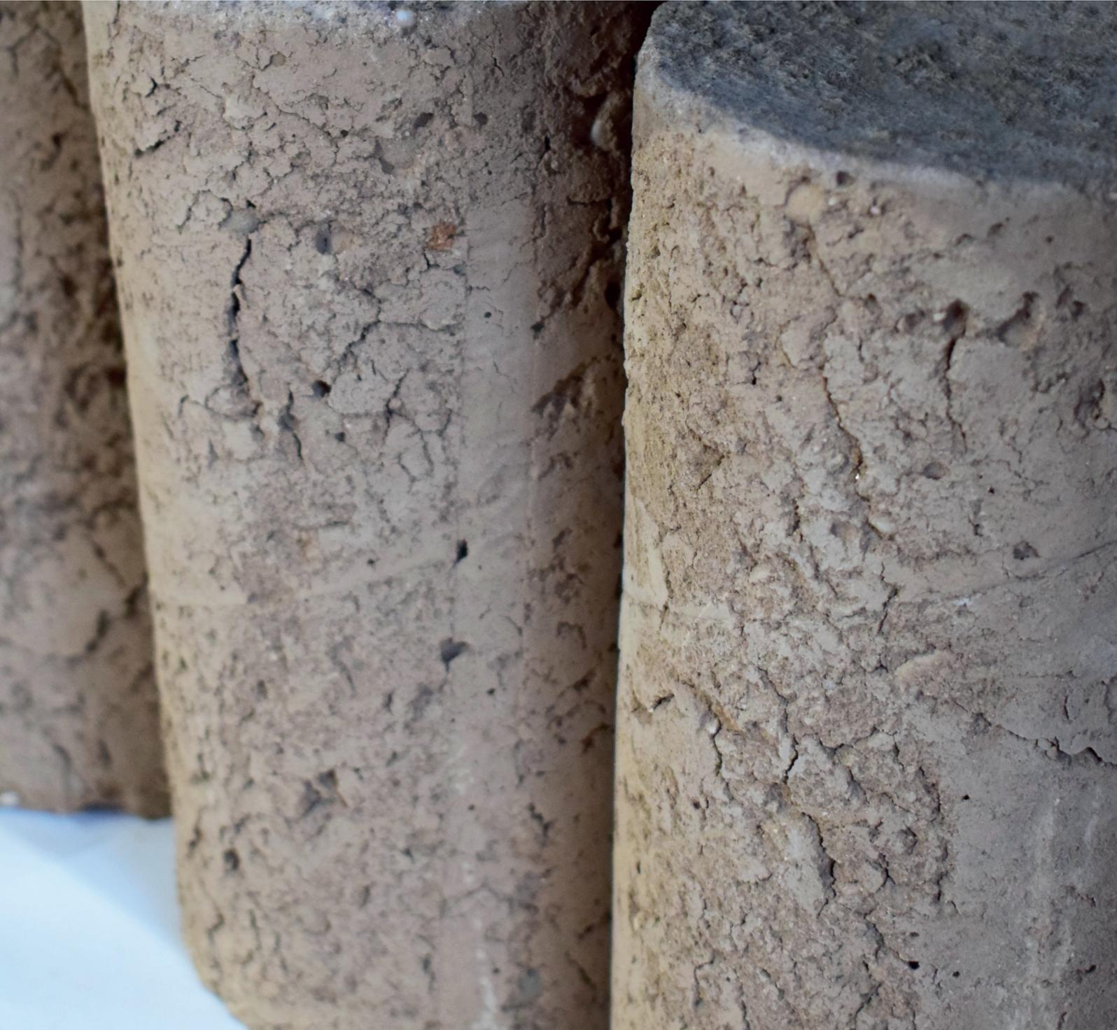
Le béton de terre crue est composé de sable, de gravillons, de terre et d'eau.
